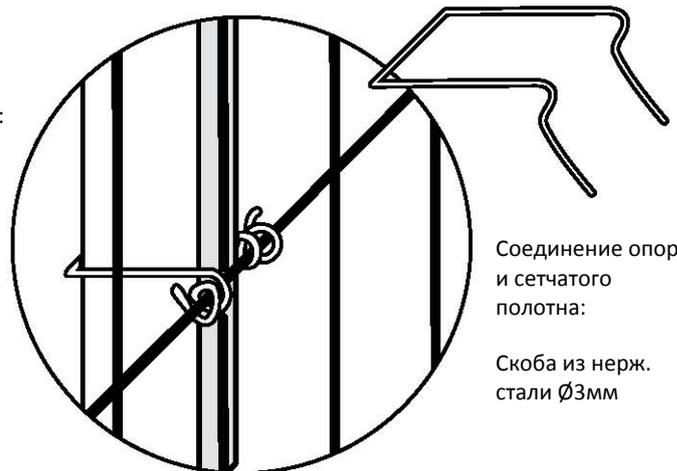
Соединение опоры и сетчатого полотна:
