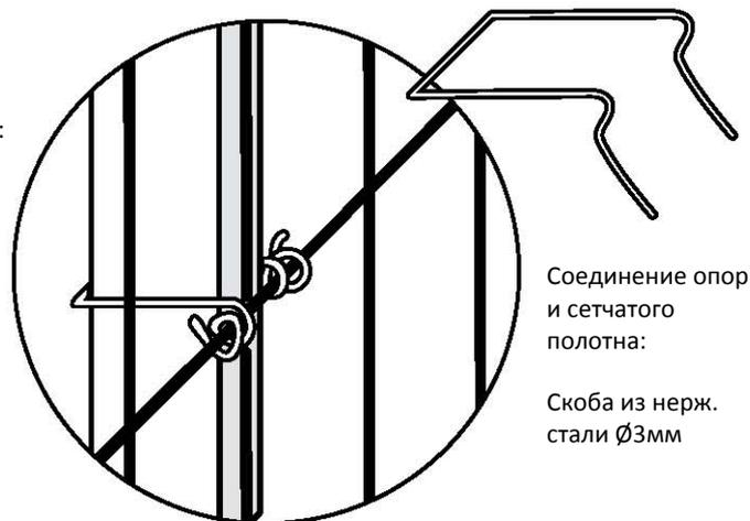
Соединение опоры и сетчатого полотна:
