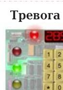
Горит светодиод тревоги. На дисплее отображается расстояние до места проникновения в метрах.
