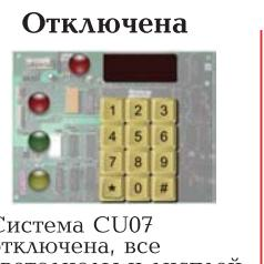
Система CU07 отключена, все светодиоды и дисплей выключены
